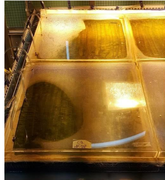
Phụ lục 8. Hệ thống TL-PSBR phương nghiêng quy mô lớn 1 m 2 sau khi được cải tiến lần 1
