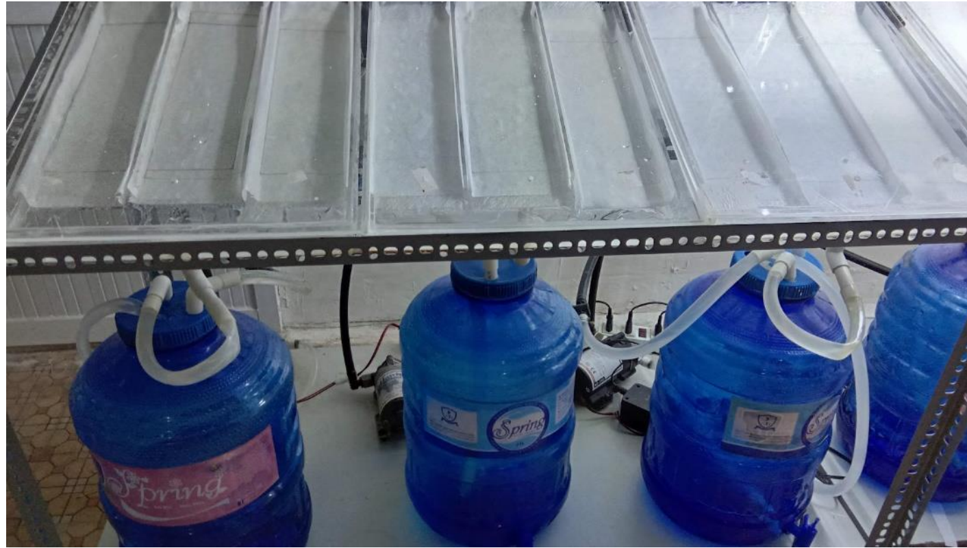
Phụ lục 4. Hệ thống TL-PSBR phương nghiêng quy mô nhỏ sau khi được cải tiến lần 2
