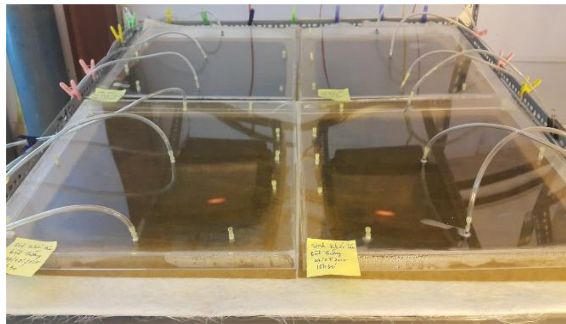
Phụ lục 8. Hệ thống TL-PSBR phương nghiêng quy mô lớn 1 m 2 sau khi được cải tiến lần 1
